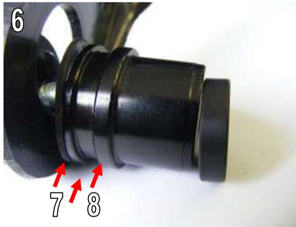
7. Montieren Sie die Handprotectoren mit den Lenkerendeneinsätzen und ziehen Sie die Inbusschraube M6x40 (12) fest. Befestigen Sie die Handprotectoren mit den M6 x 20 Schrauben (5) und M6 Muttern (3) an den Halterungen Abb.7 / Fit hand guards using bar end inserts and tighten M6x40 cap socket screw (12). Fit the hand guards to the brackets using the M6 x 20 screws (5) and M6 Flange nuts (3) Fig.5
