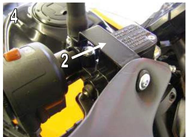
6. Montieren Sie die Lenkerendeneinsätze an beiden Handprotectoren. Ziehen Sie die Schraube zu diesem Zeitpunkt noch nicht fest Abb.5+6 / Fit bar end assembly to both hand guards. Do not tighten up the screw at this stage Fig.5+6
