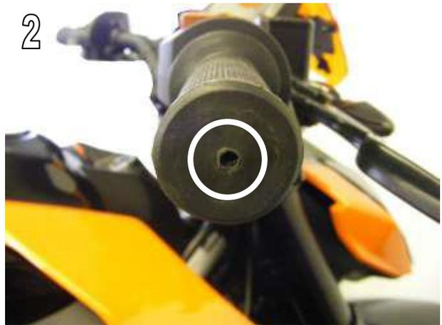
4. Setzen Sie die Distanz (10) in den Ausschnitt. **STELLEN SIE SICHER, DASS DER GASGRIFF SICH FREI DREHEN KANN!** / *Place Spacer (10) into cut out made in bar end. ENSURE THROTTLE CAN FREELY SPIN WHEN SPACER IS IN POSITION!*
